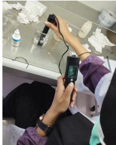
Mengukur sampel air laut menggunakan DO
