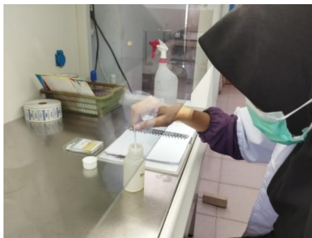
Uji Sampel air menggunakan kertas lakmus
